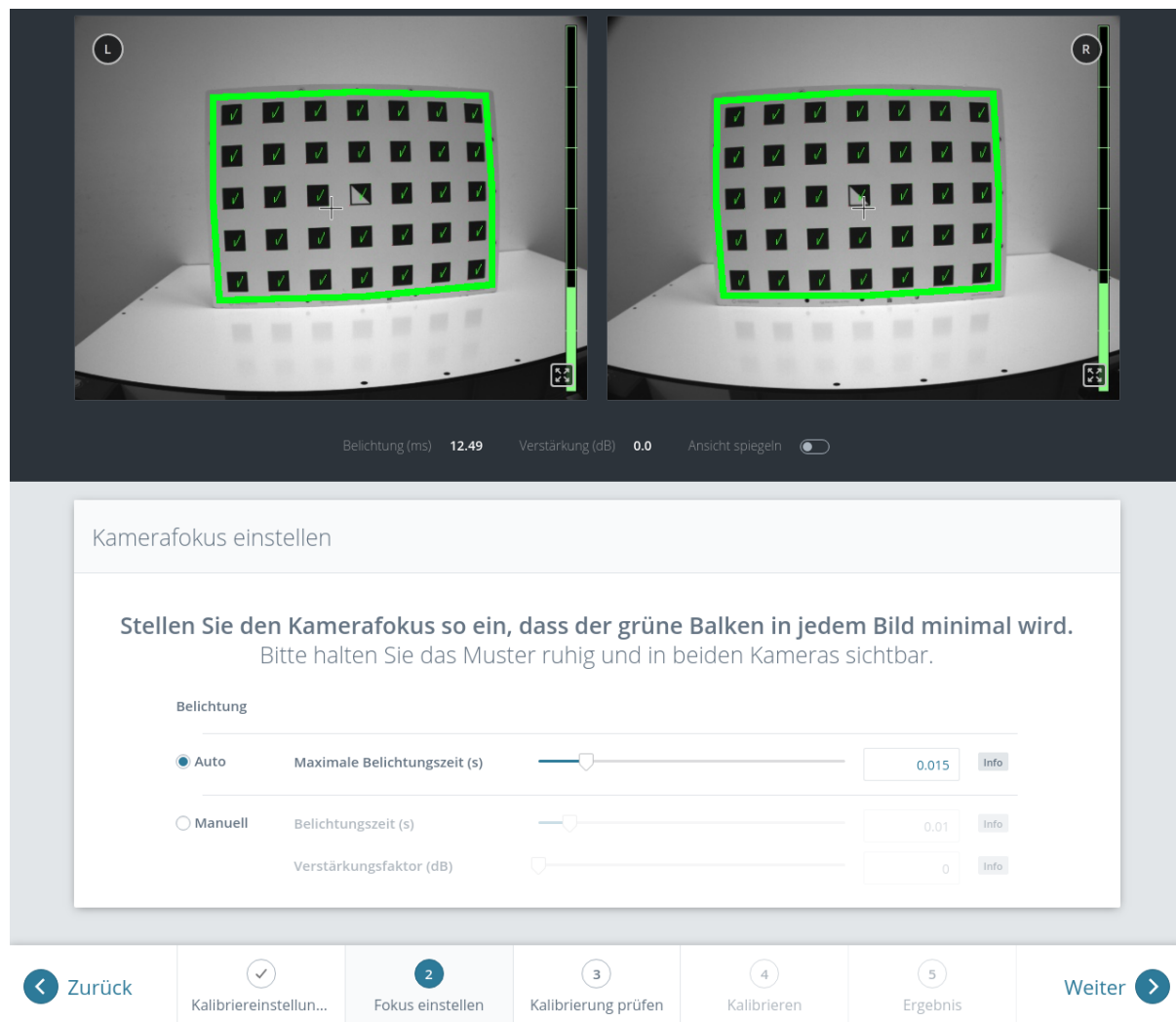
Abb. 5.28: Fokuseinstellung jeder Kamera
