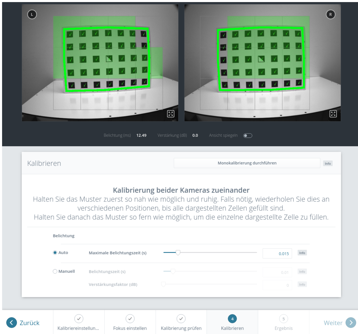
Abb. 5.31: Stereokalibrierung: Das Muster sollte so nah wie möglich gehalten werden, um alle dargestellten Zellen zu füllen.
