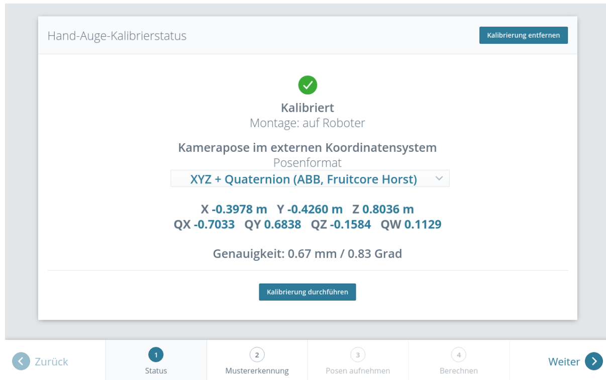
Abb. 5.21: Aktueller Status der Hand-Auge-Kalibrierung falls eine Hand-Auge-Kalibrierung gespeichert ist
