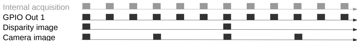
Abb. 6.34: Beispiel für die Nutzung der Betriebsart ExposureActive für GPIO-Ausgang 1 mit einer benutzerdefinierten Bildwiederholrate von 8 Hz. Die interne Bildaufnahme geschieht immer mit 25 Hz. GPIO-Ausgang 1 ist für die Dauer der Belichtungszeit jedes Bildes an (HIGH). Disparitätsbilder werden für Kamerabilder berechnet, die auch per GigE Vision in der benutzerdefinierten Bildwiederholrate versendet werden.
